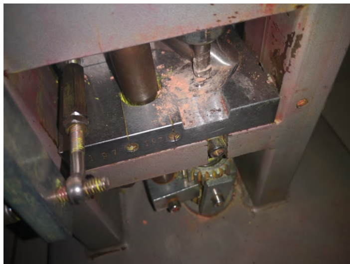
Fotografía N°09 “Detalle máquina manual para manufactura de comprimidos”
