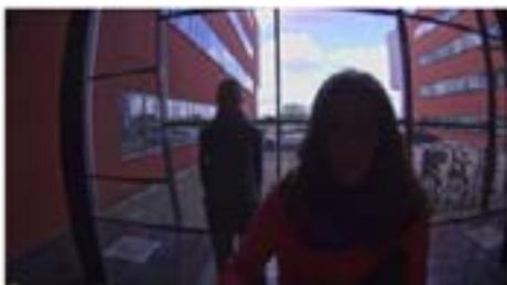
Logran una toma de altura y resolución ideal para identificación mediante un software de reconocimiento facial, pero el fuerte contraste de luz exterior deteriora la imagen.
