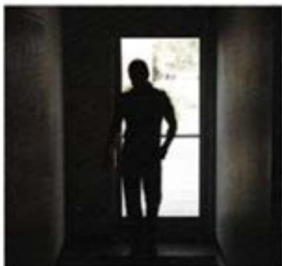
Contraste. Uno de los problemas que se da, de forma recurrente en la instalación de cámaras destinadas al control de acceso a un local, es el fuerte contraste generado por la luz que proviene del exterior, ya sea porque existe un frontis de vidrio, o porque esta ingresa al momento de abrir la puerta.
